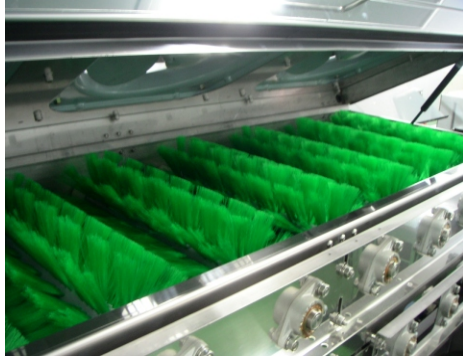
Yıkama Ünitesi (OP)
